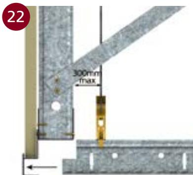
■ VERTICAL SCREW-FIX SYSTEM DETAIL
